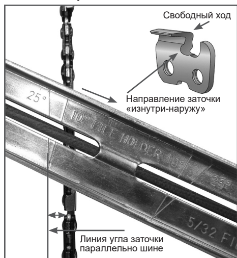
Рис. 17 Определение угла заточки
