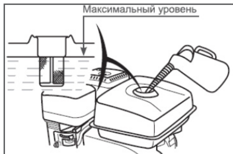
Рис. 7 Максимальный уровень топлива в топливном баке
