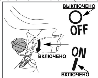
Рис. 13 Выключатель зажигания в положении «Включено»
