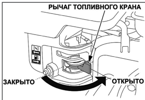
Рис. 10 Топливный кран открыт
