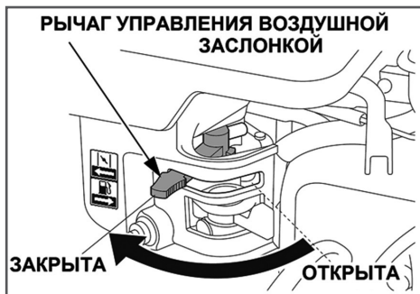
Рис. 11 Воздушная заслонка закрыта
