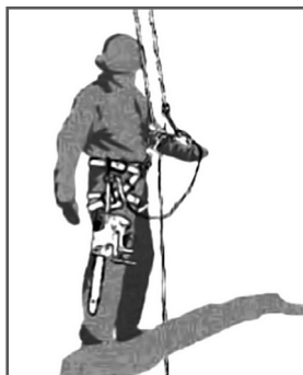
Рис. 19 Пример крепления пилы к ремню оператора
