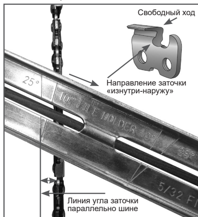
Рис. 28 Определение угла заточки
