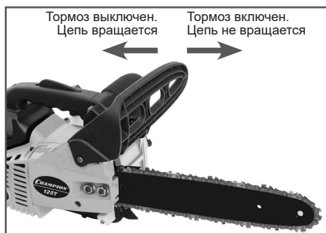
Рис. 6 Проверка механического тормоза цепи
