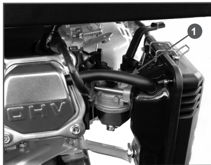
Рис. 12 Трубка системы вентиляции картера
