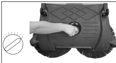
Рис. 7 Положение ручки регулятора высоты установки щеток
