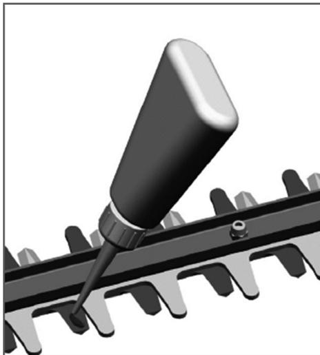
Рис. 5 Смазка режущих ножей
