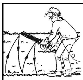
Рис. 4 Движения ножницами при обрезке
