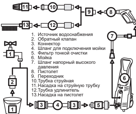
Рис. 12 Схема подключения аппарата моющего высокого давления с дополнительным оборудованием
