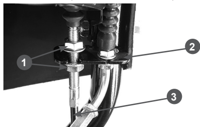
Рис. 10 Крепление оболочки троса включения хода
