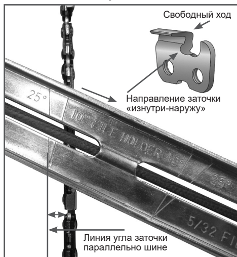
Рис. 23 Расположение линии угла заточки
