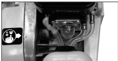
Рис. 5 Ручной топливный насос
