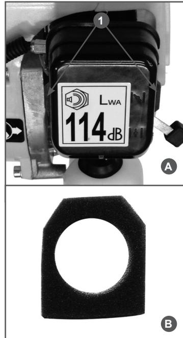
Рис. 12 Обслуживание воздушного фильтра
