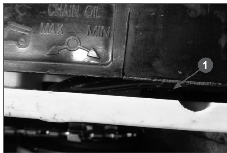
Рис. 8 Винт регулировки подачи масла 1. Винт регулировочный
