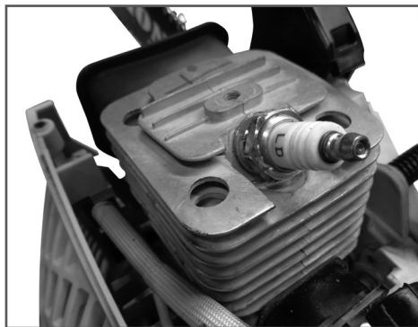
Рис. 29 Охлаждающие ребра цилиндра
