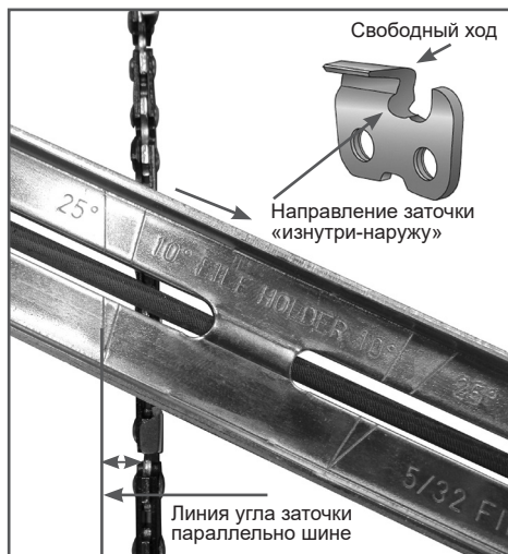
Рис. 23 Расположение линии угла заточки
