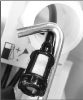
Рис. 17 Извлечение топливного фильтра
