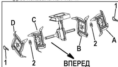
**Рис. 4 Установка фрез**
