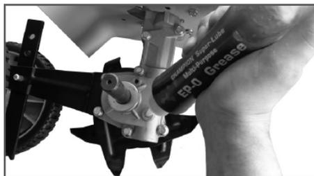
Рис. 20 Добавление смазки в корпус редуктора
