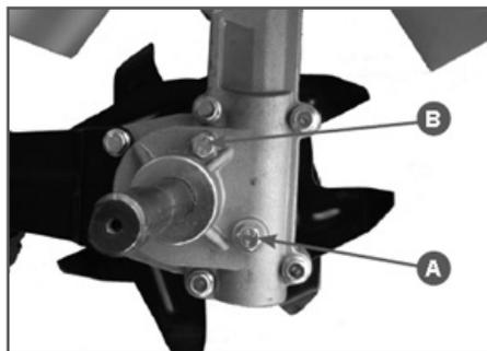
Рис. 19 Обслуживание редуктора
