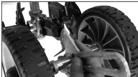
**Рис. 6 Установка кронштейна колес**
