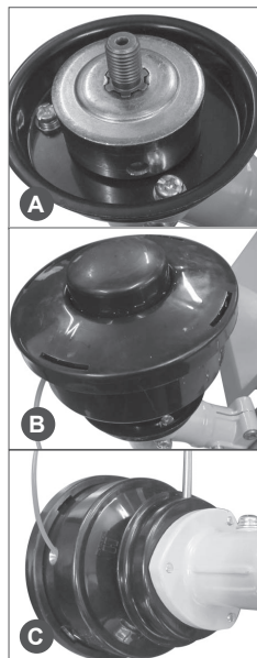
Рис. 5 Установка триммерной головки
