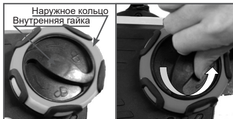
Рис. 3 Регулятор натяжения цепи / гайка крышки шины
