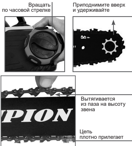
Рис. 6 Регулировка натяжения цепи
