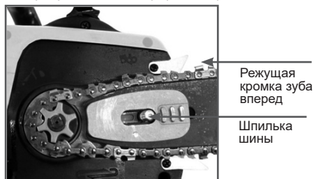
Рис. 4 Установка цепи и шины
