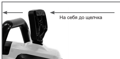
Рис. 2 Положение ручки тормоза цепи
