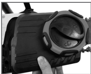
Рис. 5 Установка крышки шины
