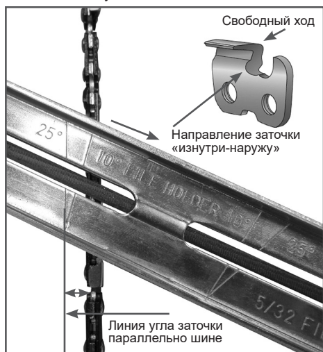
Рис. 17. Определение угла заточки
