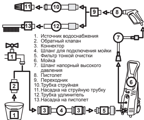
Рис. 12 Схема подключения аппарата моющего высокого давления с дополнительным оборудованием
