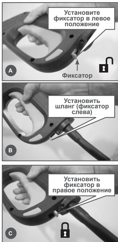
Рис. 3 Подключение шланга высокого давления к пистолету
