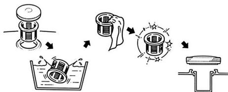
Рис. 19 Обслуживание сетчатого фильтра в горловине топливного бака
