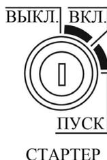
Рис. 12 Замок зажигания
