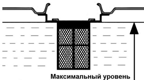
Рис. 9 Максимальный уровень топлива в топливном баке
