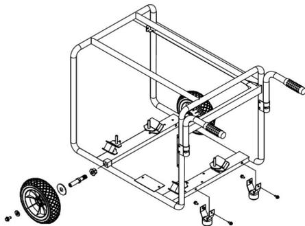
Рис. 4 Установка транспортировочных колес и опор рамы
