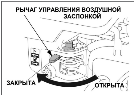
Рис. 10 Рычаг управления воздушной заслонкой
