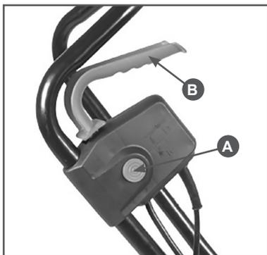
Рис. 9 Включение культиватора
