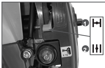
Рис. 4 Положения рычага управления воздушной заслонкой карбюратора
