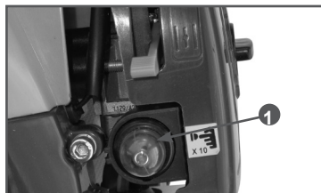
Рис. 3 Расположение ручного топливного насоса
