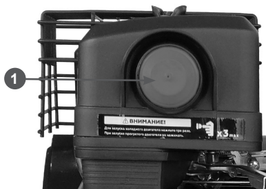
Рис. 34 Расположение ручного топливного насоса
