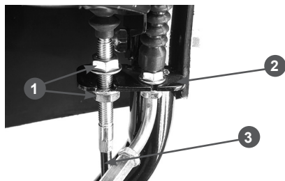
Рис. 11 Крепление оболочки троса включения хода
