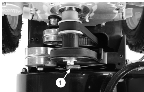
Рис. 9 Регулировка троса включения шнеков
