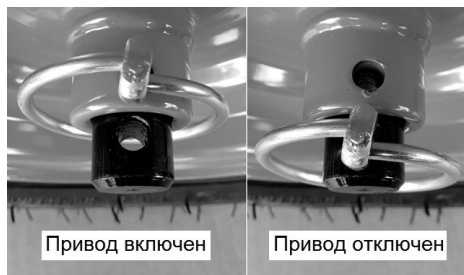
Рис. 36 Перестановка шплинта на левом колесе
