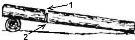
Рис. 11. Пропилы при раскряжевке дерева на одной опоре
