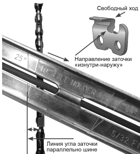
Рис. 15. Определение угла заточки
