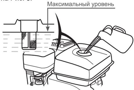
Рис. 8. Максимальный уровень топлива в топливном баке
