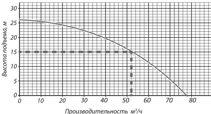
Рис. 25 График зависимости производительности мотопомпы от высоты подъема
