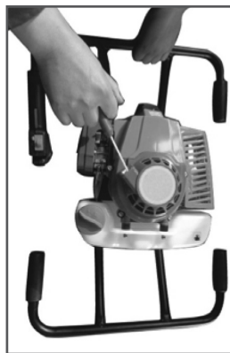
Рис. 9 Свободный ход шнура стартера
