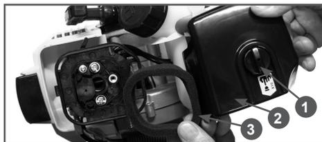
**Рис. 9 Обслуживание воздушного фильтра**
