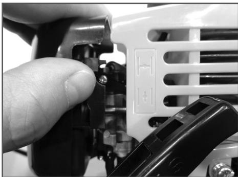
Рис. 4 Рычаг управления воздушной заслонкой в положении «ЗАКРЫТО»
