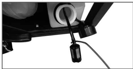
Рис. 11 Извлечение топливного фильтра
