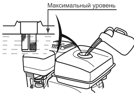
Рис. 5 Максимальный уровень топлива в топливном баке
