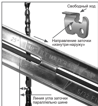
Рис. 26 Определение угла заточки
