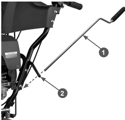
Рис. 23 Установка рычага управления поворотом жёлоба
