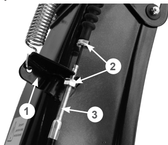
Рис. 21 Установка оболочки троса управления дефлектором жёлоба
