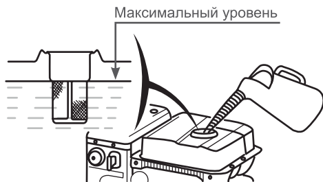
Рис. 28 Максимальный уровень топлива в топливном баке
