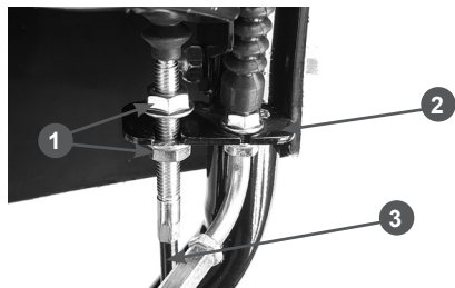
Рис. 10 Крепление оболочки троса включения хода
