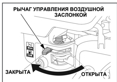
Рис. 24 Рычаг управления воздушной заслонкой
