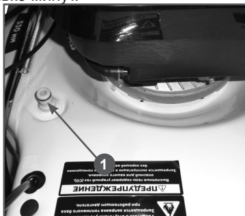
Рис. 29 Расположение коннектора для подключения шланга
