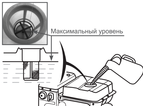
Рис. 8 Максимальный уровень топлива в топливном баке
