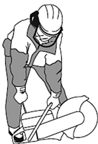
Рис. 8 Положение оператора при запуске двигателя
