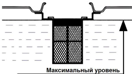
Рис. 10 Максимальный уровень топлива в топливном баке
