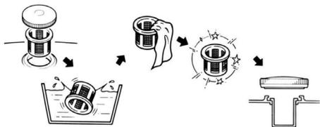
**Рис. 18 Обслуживание сетчатого фильтра в горловине топливного бака**
