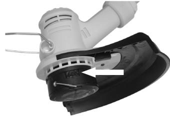
Рис. 4 Снятие крышки триммерной головки
