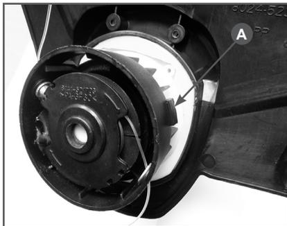
Рис. 6 Установка катушки на вал корпуса триммерной головки
