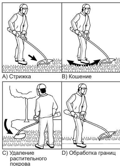
Рис. 11 Виды работ, выполняемых триммером
