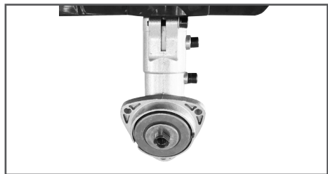
Рис. 7 Установка защитной шайбы редуктора
