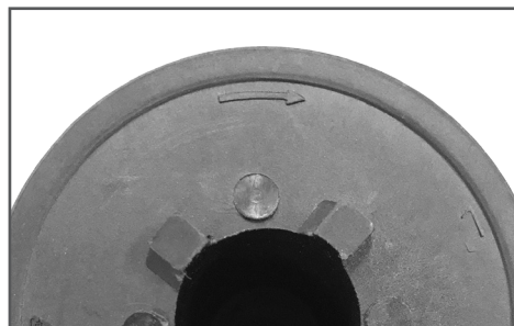
Рис. 16 Направление намотки корда на катушку
