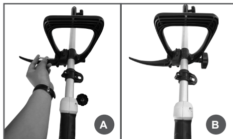
Рис. 6 Установка рабочей рукоятки
