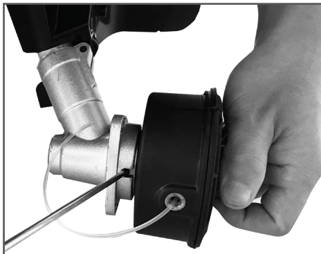
Рис. 10 Установка триммерной головки
