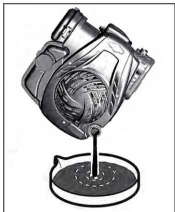
Рис. 18 Замена масла в двигателе
