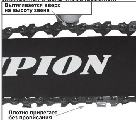
Рис. 7 Регулировка натяжения цепи
