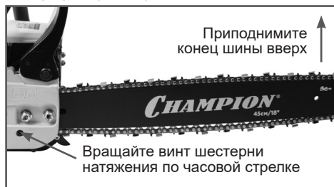
Рис. 5 Регулировка натяжения цепи
