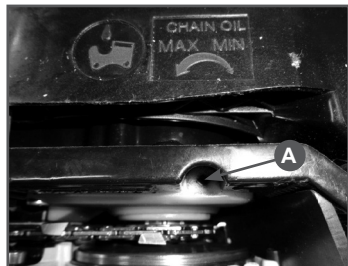
Рис. 11 Положение регулировочного винта подачи масла
