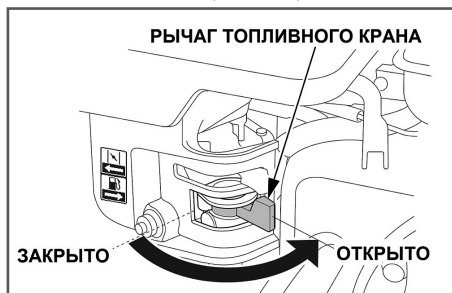
Рис. 11 Рычаг топливного крана
