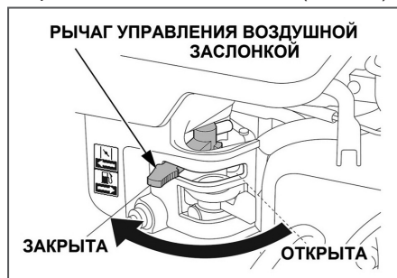
Рис. 10 Рычаг управления воздушной заслонкой
