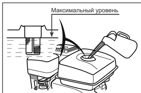
Рис. 9 Максимальный уровень топлива в топливном баке
