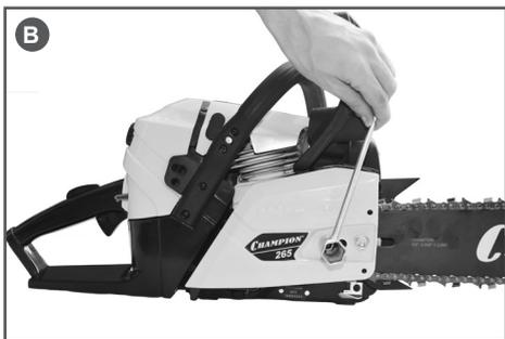
Рис. 5 Затяжка гайки крепления шины
