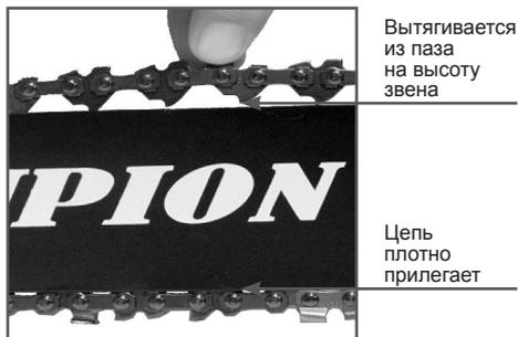
Рис. 6 Регулировка натяжения цепи
