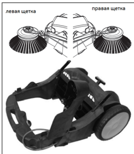
Рис. 14 Замена ремня привода круглой щетки
