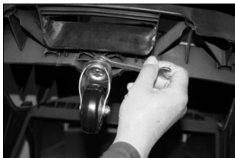
Рис. 16 Проверка затяжки крепления переднего колеса
