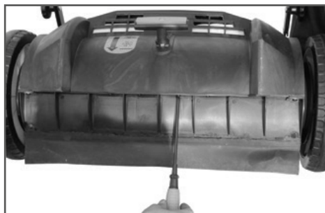
Рис. 12 Снятие крышки корпуса
