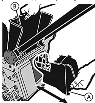
Рис. 15 Установка заглушки для мульчирования
