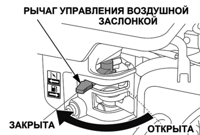
Рис. 9 Воздушная заслонка закрыта
