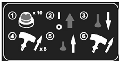
Рис. 10 Алгоритм запуска двигателя
