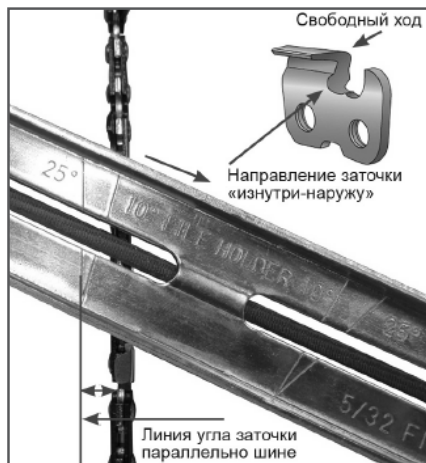
Рис. 14. Определение угла заточки
