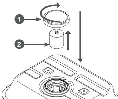
Рис. 4А Установка крышки бака и мерного стаканчика
