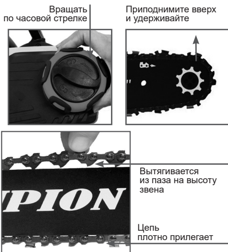
Рис. 6 Регулировка натяжения цепи
