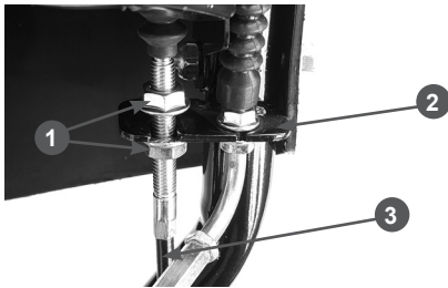
Рис. 10 Крепление оболочки троса включения хода
