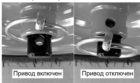
Рис. 28 Перестановка шплинта на левом колесе
