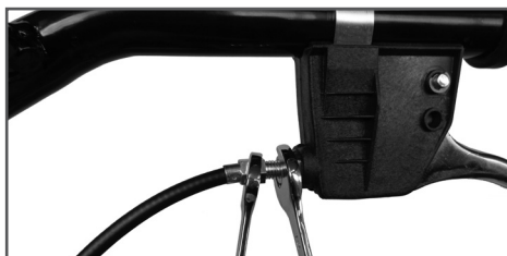
Рис. 12 Фиксация троса газа
